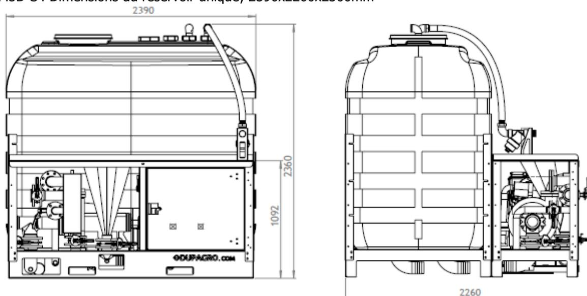
M5D-S4-2M Dimensions du réservoir double; 2390x3625x2360mm
